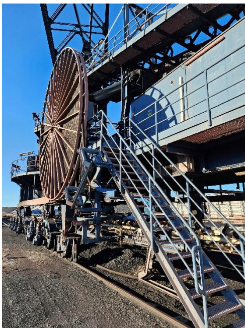
Slika 2 - 3. Prikaz trenutne lokacije navijalnega bobna vodne cevi na kombiniranem stroju
